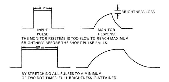
SIMPLE LOGIC ADDS ONE PULSE TO THE TRAILING EDGE OF ANY INCOMING PULSE
