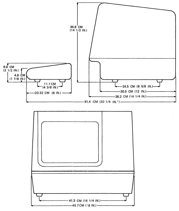
\*MEASUREMENT TAKEN WITH THE KEYBOARD PLACED FLUSH TO FRONT OF TERMINAL UNDER UNDERCUT.
