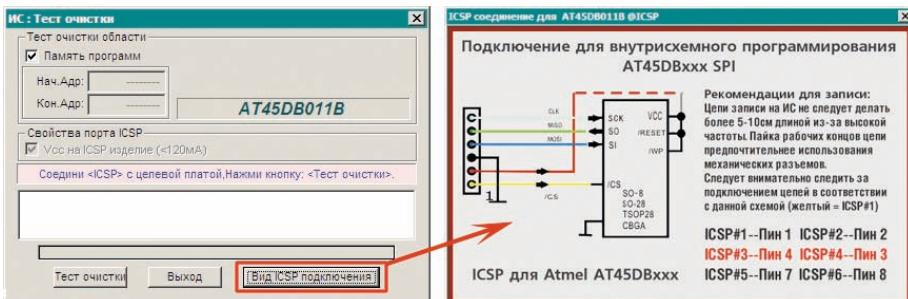
Схемы подключения WizardProg 87i для ICSP известных изготовителей ИС
