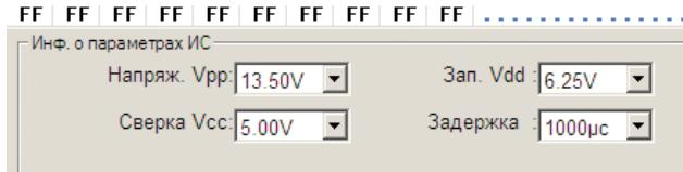
Поскольку наборы параметров у функционально различных устройств не одинаковы – вид буфера конфигурации обычно меняется в соответствии с типом и номиналом выбранного в п. 3.3 устройства.
