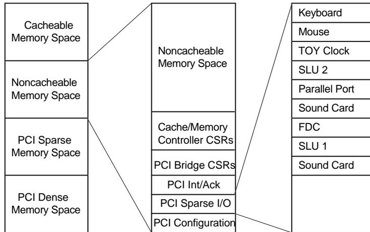
**Figure 3-6. PCI Sparse Address Space**
